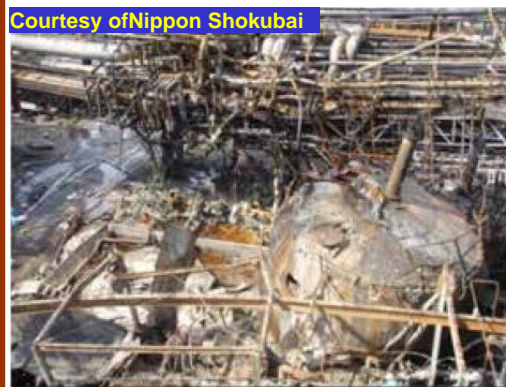
Зураг 1: Акрилын хүчилтэй эвдэрсэн танк
