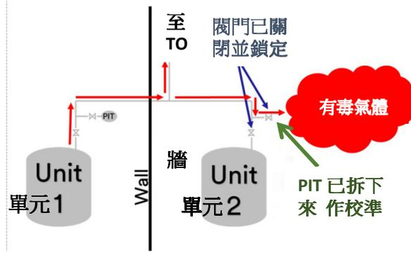
單元1和2共用一條管子通到熱氧化器 (thermal oxidizer, TO)。在單元2上有幾個儀器要進行定期校準。故將手動閥關閉並且鎖定，再拆下壓力傳訊器 (PIT) 以進行校準。
