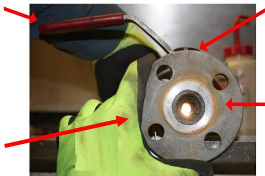
Valvola manuale guasta, con conseguente leva ruotata senza chiusura della valvola
