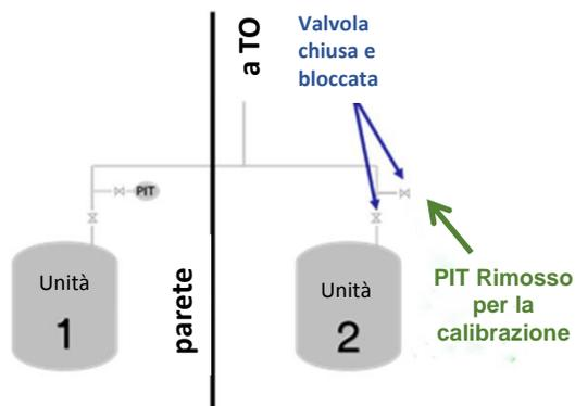
Unità 1 e 2 condividevano la stessa linea verso l'ossidatore termico (TO). Diversi strumenti dovevano essere calibrati nell'unità 2. Una valvola manuale venne chiusa e lucchettata prima di rimuovere il trasmettitore di pressione (PIT) per la calibrazione.
