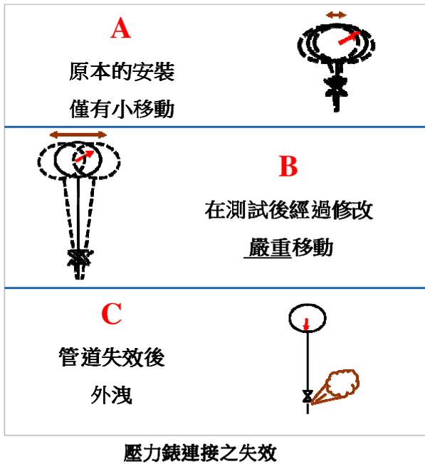
有部新壓縮機系統正在開始運作（圖A）。在臨時故障排除過程時，對壓力錶的連接作了修改（圖B）。有條較長的管子留在原處，又將它重新連接到壓力錶。壓縮機的振動以及較長管子增加了移動量。終於接頭失效了，導致大量可燃性氣體外洩，所幸該可燃氣體並未點燃，但造成嚴重的環境外洩事件。（圖C）
