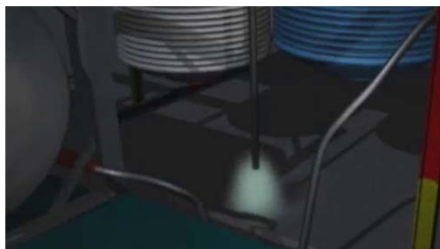
Obrázek 2. Procesní páry uvolněné na podlahu poblíž provozního zařízení
