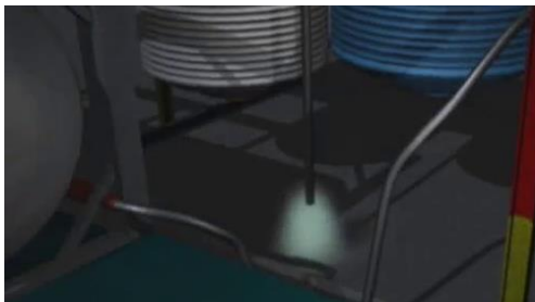
Bild 2: Prozessgase entweichen über Druckentlastungsleitung in den Produktionsbereich
