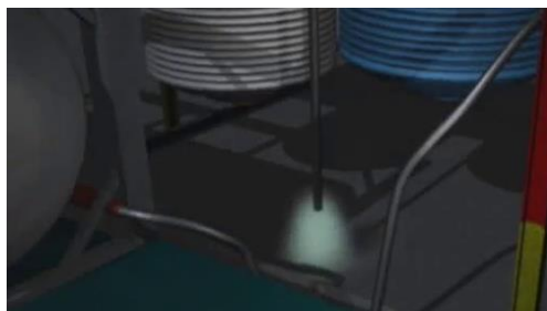
Rys. 2. Uwolnienie oparów procesowych w najniższym punkcie w strefie prowadzonego procesu
