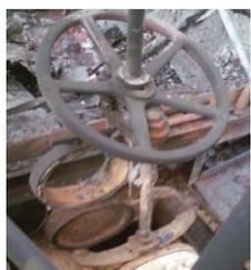
*Figure 3:* Vanne de sectionnement après l'accident
