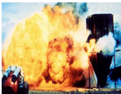
איור 2: אבק שהשתחרר לאטמוספירה ממשיך לבעור מחוץ לכלי
