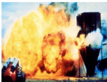
Figura 2: La polvere rilasciata continua a bruciare fuori dal serbatoio
