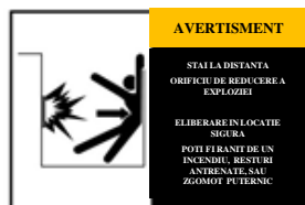
Figura 3: Semnalizare privind locația eliberării controlate
