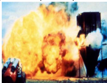
Figura 2: Pulberea eliberată continuă să ardă în exteriorul vasului
