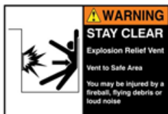
รูปที่ 3: ป้ายเตือนจุดที่มีช่องระบายความดันจากการระเบิด (explosion relief)
