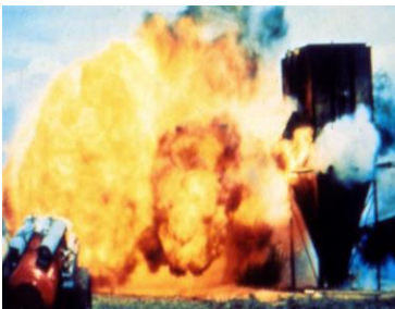
รูปที่ 2: ฝุ่นที่ถูกปลิวออกมา ยังคงติดไฟอย่างต่อเนื่องด้านนอกของถัง
