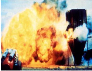
Şekil 2: Vent edilen toz, tankın dışında yanmaya devam ediyor.
