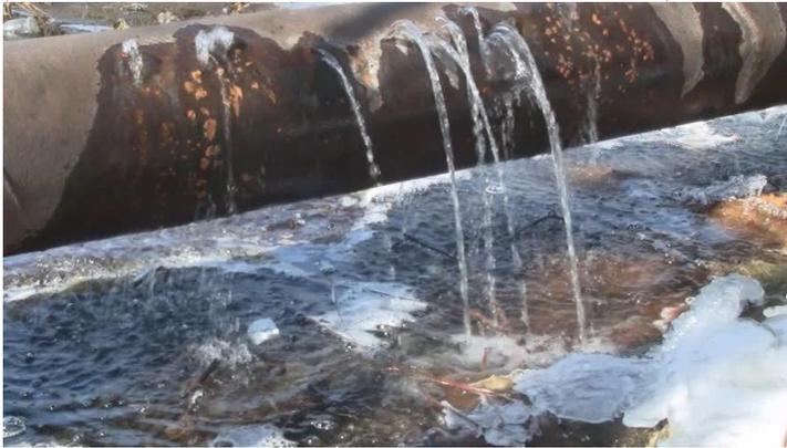
ある会社がある化学製品の製造の停止を決定した。原料の1つは、有毒で腐食性の三塩化リン( $\text{PCl}_3$ )であった。貯蔵タンクへの配管とプロセスエリアから $\text{PCl}_3$ を取り除いた。数年後、運転員が屋外で漏れを発見した。調査の結果、漏洩は「空」の $\text{PCl}_3$ 配管から発生していることが判明した。負傷者はなく、外部流出は回避された。
