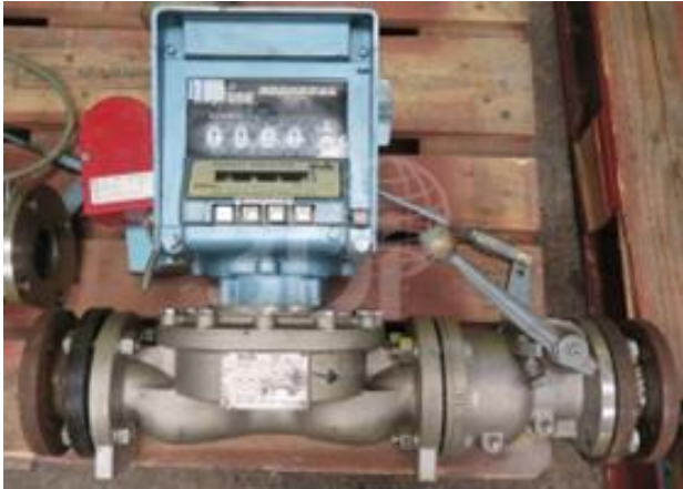
Figur 1. Strømmåler klar til kalibrering
