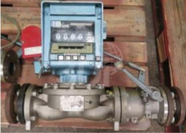
Abb. 1. Durchflussmesser, bereit zum Kalibrieren
