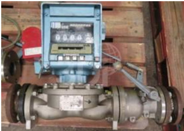
Figura 1. Debitmetru pregătit pentru calibrare
