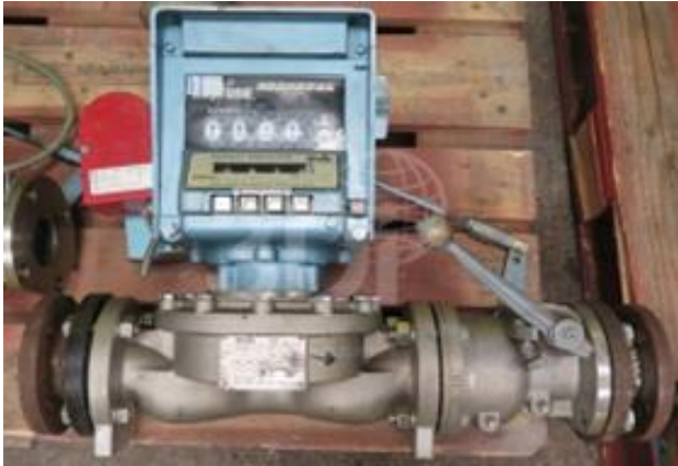
Рис.1 Расходомер готов к калибровке
