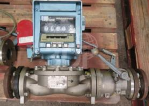
Şekil 1. Kalibrasyona hazır akış ölçer
