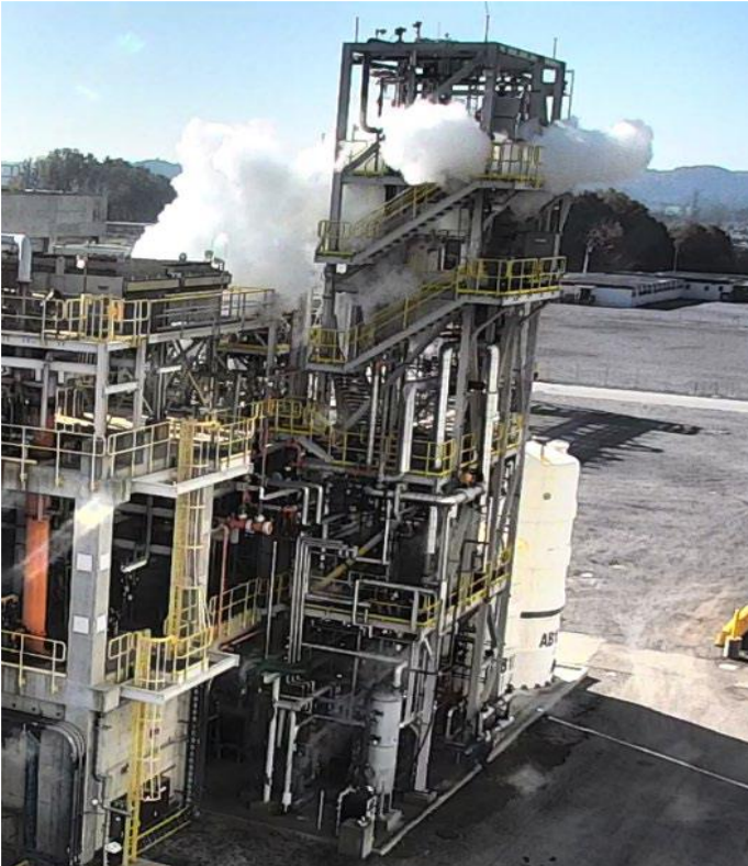
Kuva 1. Hoitotaso, missä vuoto tapahtui. Viisitoista sekuntia myöhemmin kaasupilvi nielaisi rakenteen (Ref CSB report No. 2021-01-I-TN)
