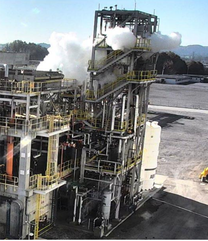
Şekil 1. Salımın gerçekleştiği platform. On beş saniye sonra, yapı bulut tarafından yutuldu. (Ref CSB raporu No. 2021-01-I-TN)
