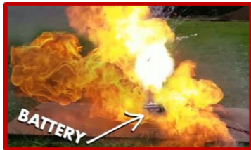
Figuur 2: Demonstratie van het branden van een lithium-ion batterij.
