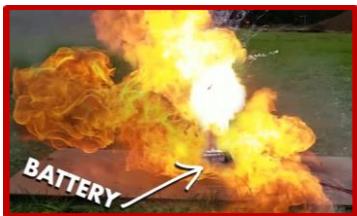
شکل ۲: نمایی از آتش سوزی ناشی از باتری لیتیوم - یون
