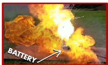
2. ábra: Lítium-ion akkumulátor égésének demonstrációja
