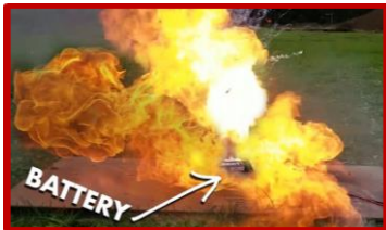
Rajah 2: Demonstrasi nyalaan bateri litium-ion.
