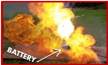
2-р зураг: Лити-ион батареи шатаж буй байдал
