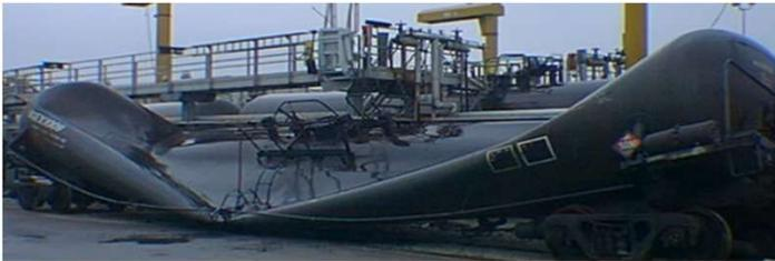
發生了什麼事？某含有易燃物質的製程正在真空狀態下操作。突然間排氣管塌陷。當真空而造成設備的內部壓力低於設備的真空額定值時，設備可能會塌陷。
