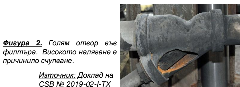
Фигура 1. Чугунен Y-образен филтър, неправилно монтиран в заварена линия от неръждаема стомана.
