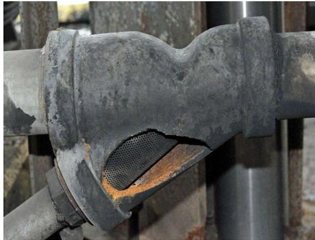
圖 2. 過濾器上的一個大孔。壓力過大導致脆性斷裂。
