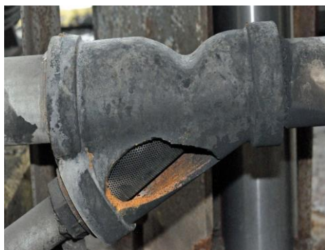
Figur 2. Et stort hul i filteret. Højt tryk forårsagede et skørt (sprødt, eng: "Brittle") metalbrud.
