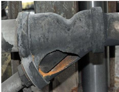
**Figure 2.** Un grand trou dans la crépine. L'excès de pression a provoqué sa rupture fragile.
