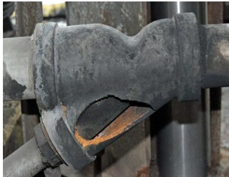
Abb 1: Schrägsitzsieb aus Grauguss, unzulässigerweise in geschweißter Edelstahl-Leitung verbaut
