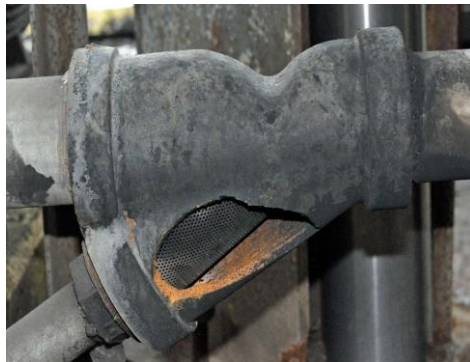
Слика 2. Голема дупка во филтерот. Прекумерниот притисок предизвикал кршење.
