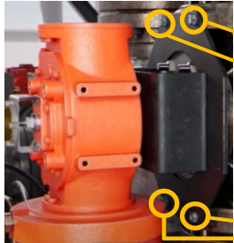
Εικόνα 1. Μηχανισμός χειρισμού βάνας με επισήμανση στους κοχλίες στήριξης
