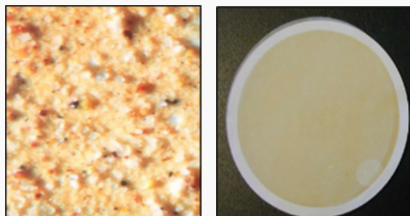
Figura N°01. Ensuciamiento coloidal (particulado)
