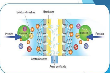
Membrana de ósmosis inversa Modelo FilmTec BW30 - 2540 (DuPont)
