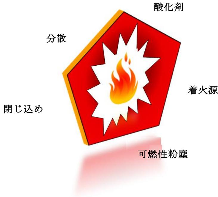
図 4. 可燃性粉塵爆発の五角形
